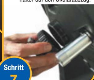
► Entfernen Sie die Staubschutzkammer vom Okularauszug.
