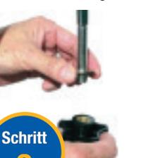
► Setzen Sie die die Spreizspanne und die Unterlegscheibe auf die Zentralstange und fixieren Sie diese mit der Konterschraube.
