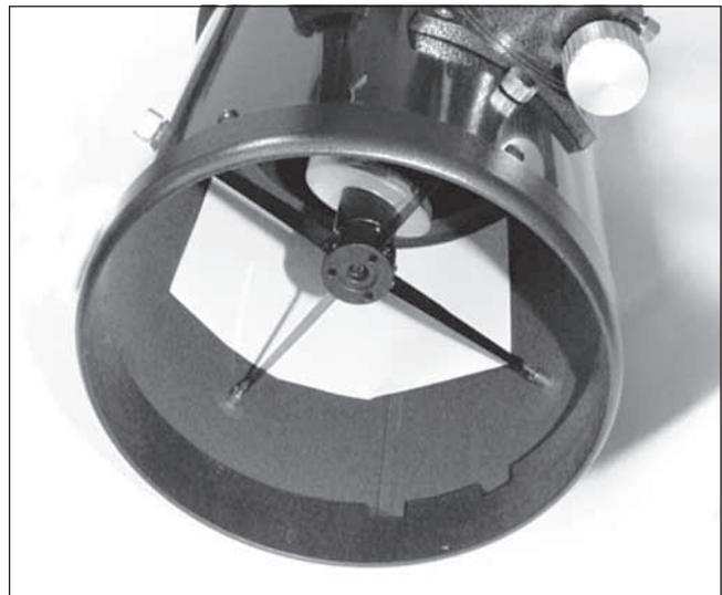
**Abbildung 10.** Legen Sie ein weißes Stück Papier gegenüber dem Fokussierer in das Optiktrohr, um bei einem Blick durch den Fokussierer einen hellen Hintergrund zu sehen.
