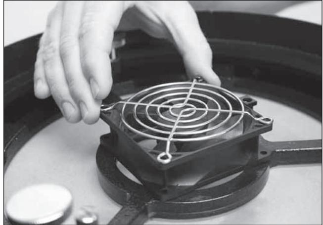
**Abbildung 4a.** Richten Sie die Bohrungen von Lüfter und Lüftergitter an den Bohrungen auf der Rückseite der Primärspiegelzelle aus.
