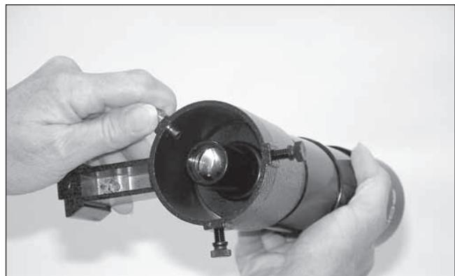
**Abbildung 3b.** Ziehen Sie die Federspannvorrichtung zurück, und schieben Sie das Sucherfernrohr so in die Halterung, dass der O-Ring in der Halterung verschwindet.
