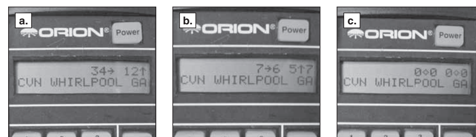
Abbildung 11. Diese Bildfolge zeigt Ihnen, wie die Richtungspfeile des Steuergeräts Ihnen dabei helfen, ein Objekt zu finden. (a.) Wenn Sie noch weit von der korrekten Ausrichtung auf ein Objekt entfernt sind, wird eine Zahl (zwischen 10 und 179) links von den Richtungspfeilen angezeigt. (b.) Wenn Sie sich der korrekten Ausrichtung auf ein Objekt nähern, wird jeweils eine Zahl unmittelbar links (zwischen 0 und 9) und unmittelbar rechts (zwischen 0 und 9) neben dem jeweiligen Richtungspfeil angezeigt. Die Zahl auf der linken Seite steht für ganze, die Zahl auf der rechten Seite für Zehntelschritte. Dies hilft Ihnen bei der allmählichen Annäherung der Ausrichtung des Optiktrohrs auf ein Objekt. (c.) Wenn statt der Richtungspfeile „0.0 0.0“ angezeigt wird, befindet sich das gewünschte Objekt im Sichtfeld des Teleskops (bei Verwendung eines Okulars mit einer Brennweite von 25 mm oder länger).
