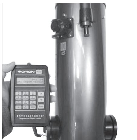
Abbildung 10. Wenn Sie links vom Teleskop stehen und in die Richtung blicken, auf die das Teleskop ausgerichtet ist, zeigen Ihnen die Richtungspfeile exakt, wie Sie das Teleskop schwenken müssen, um das ausgewählte Objekt zu finden.
