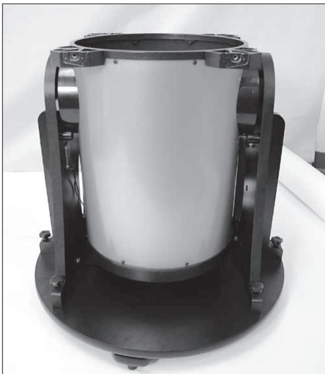
**Figure 24.** Plutôt que d'assembler tout le tube optique, puis le hisser sur la base, certains peuvent trouver plus pratique de monter d'abord la section inférieure du tube sur la base, puis d'installer les tubes Truss et la section supérieure du tube.
