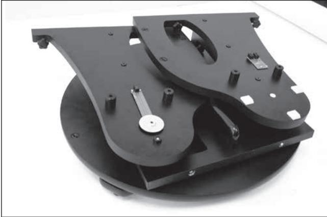
**Figure 47.** Lors du transport de la base démontée, posez les panneaux latéraux de sorte que les encodeurs soient tournés vers le haut et ne posez rien dessus afin d'éviter de les endommager.
