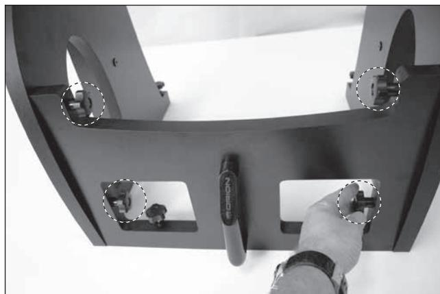
**Figure 46.** Desserrez les quatre boulons captifs d'assemblage qui fixent les panneaux latéraux sur le panneau avant.
