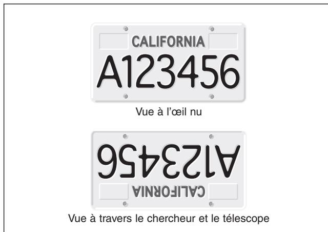
**Figure 44.** La vue à travers le chercheur droit (et d'un télescope réflecteur) est inversée à 180°.
