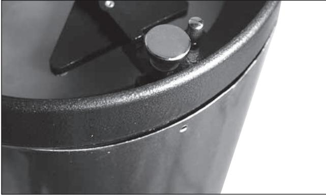
**Figure 21.** Localisez la zone de tube protubérante qui l'empêche de se placer dans la bague d'extrémité. Appuyez sur le renflement pour forcer le tube dans la bague d'extrémité.
