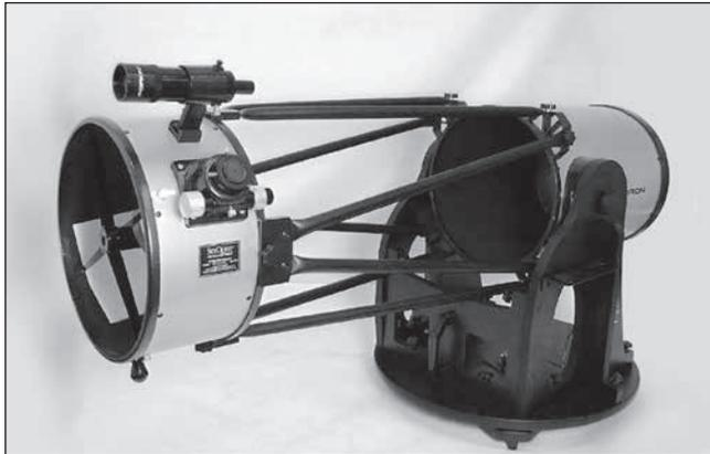
**Figure 37.** Cette image montre le XX14 correctement mis en place pour la collimation. Remarquez le papier blanc placé en regard du porte-oculaire et l'orientation horizontale du tube optique. Idéalement, le télescope doit être pointé vers un mur aux couleurs claires.
