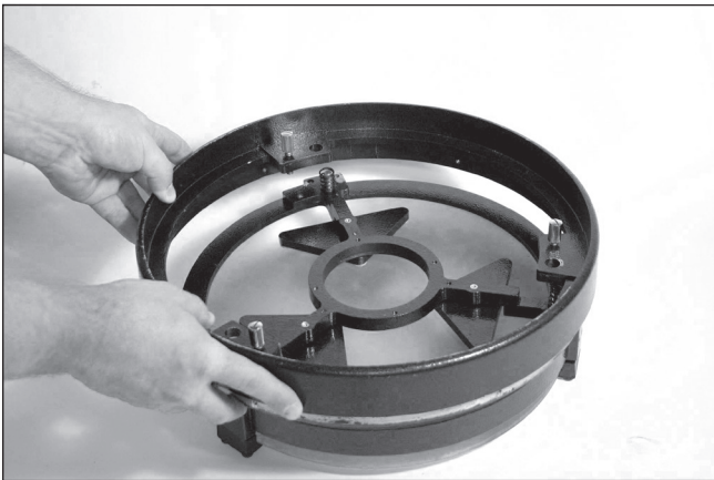
Abbildung 1.4. Senken Sie den hinteren Endring so auf die Spiegelzelle ab, dass die Gewindeschäfte durch den Endring passieren, und der Endring auf den Federn ruht.
