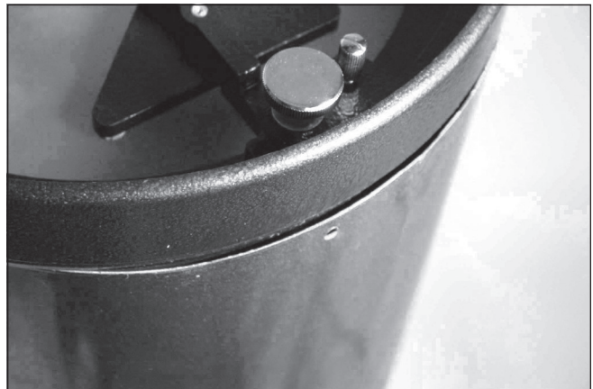
Abbildung 1.7. Suchen Sie den ausgebeulten Bereich des Optikrohrs, der verhindert, dass die Spiegelzelle vollständig richtig sitzt.
