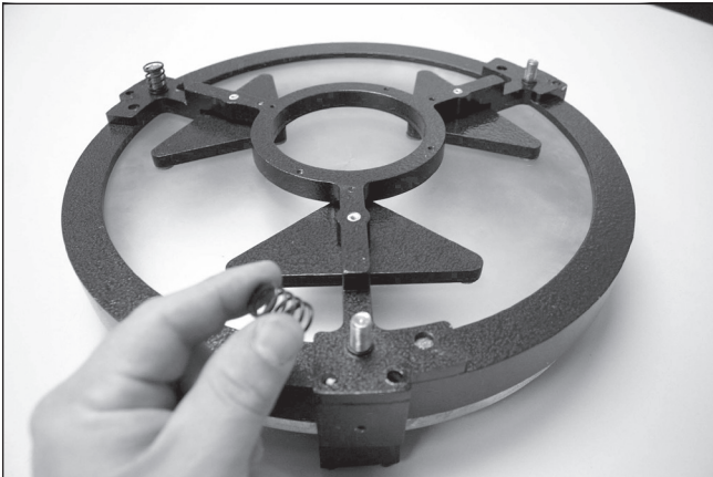
Abbildung 1.3 Legen Sie die drei Federn auf die frei liegenden Gewindeschäfte der Spiegelzelle.
