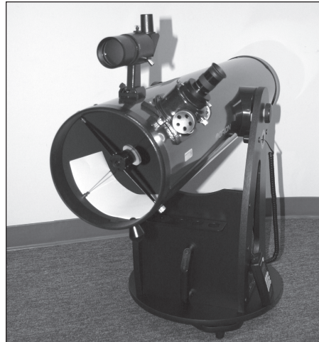
Abbildung 20. Optiktrohr des SkyQuest XTi IntelliScope-Teleskops mit richtiger Einstellung zur Kollimation. Beachten Sie das gegenüber dem Fokussierer platzierte weiße Papier und die waagerechte Lage des Optiktrohrs. Idealerweise sollte das Teleskop auf eine weiße Wand gerichtet sein.
