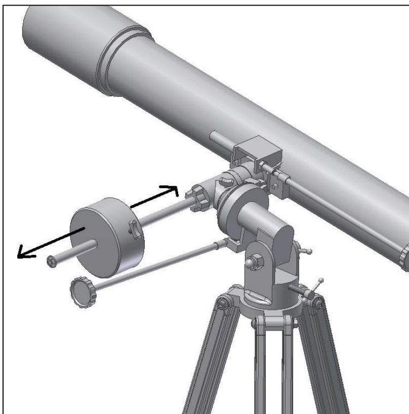
Fig. 10. Équilibrage de l'axe de l'ascension droite avec le contreponds.
