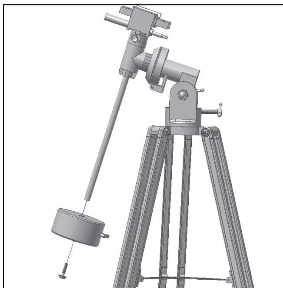
Fig. 5. Insérez la tige de contreponds puis le contreponds.
