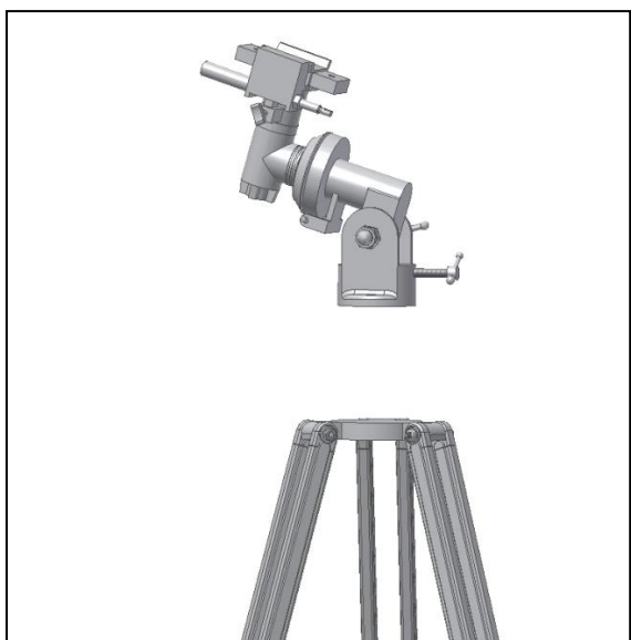
Fig. 4. Installez la tête de la monture sur le trépied.
