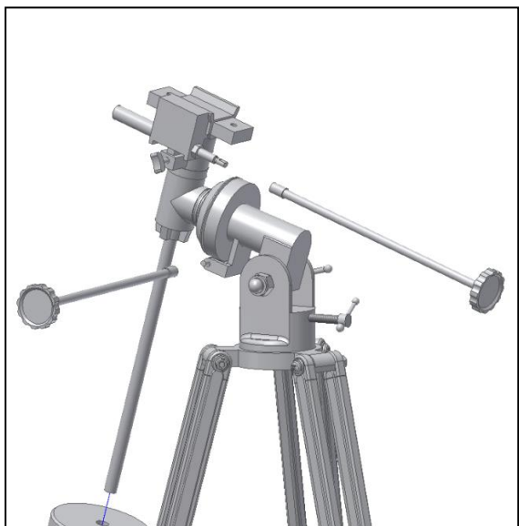
Fig. 6. Fixez les flexibles de Déc. et A.D.
