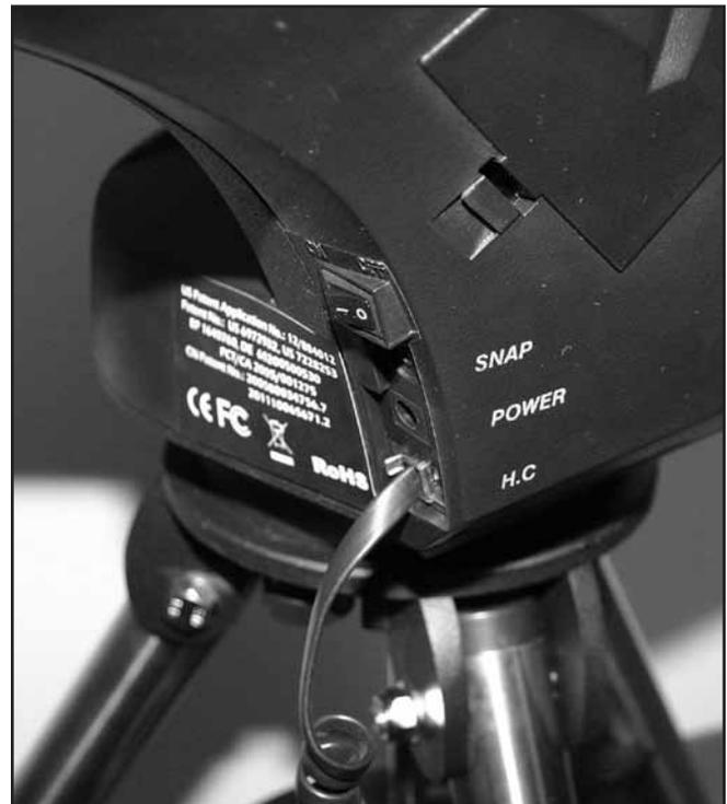
**Figura 16** Le porte elettroniche per l'unità di controllo manuale e una batteria da 12 VCC opzionale si trovano alla base del braccio della montatura. La porta SNAP permette il controllo di una fotocamera DSLR con un apposito cavo.
