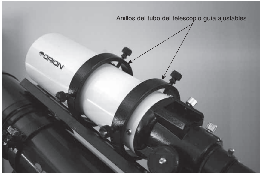
Figura 2. Los anillos del tubo del telescopio guía ajustables le permiten ajustar la posición del telescopio guía sin mover el telescopio de imágenes principal.
