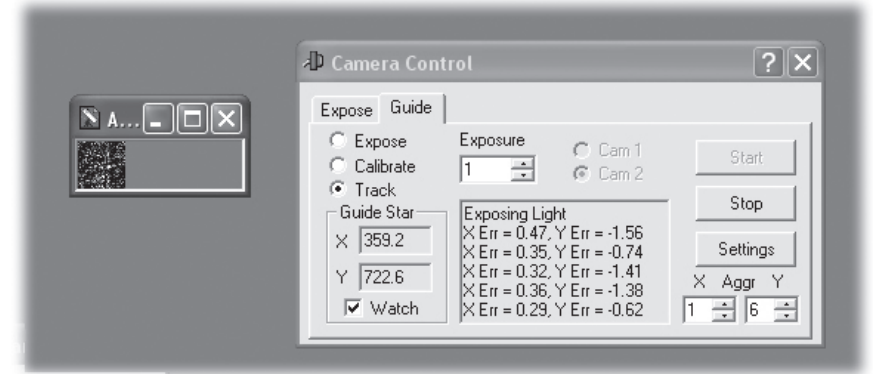
Figura 14. El guiado automático en Maxim DL muestra la estrella guía en una pequeña ventana con la casilla activada Watch (Mirar). Las correcciones de seguimiento también se muestran en la ventana Camera Control (Control de la cámara).
