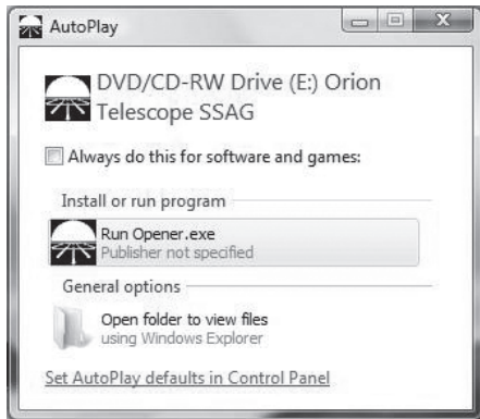
Figura 7. En Windows Vista, la pantalla Reproducción automática aparece al insertar el CD-ROM en el ordenador. Seleccione Ejecutar Opener.exe cuando aparezca esta pantalla.
