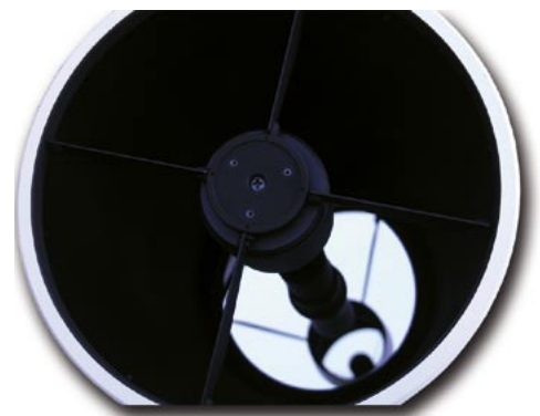
▶ Abb. 3: Ein Blick in den Tubus lässt die dünnen Fangspiegelstreben erkennen. Die Gummipolsterung mit dem Herstellerlogo wurde hier entfernt, sodass die Justierschrauben für den Sekundärspiegel frei zugänglich sind.
